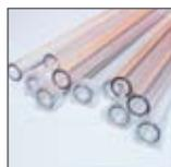
n°25 **Provette** in stiroloacrilonitrile della lunghezza di 18 cm, e larghezza di passaggio interno f 9 mm. Il contenitore trasparente è dotato di un apposito taglio sottile lungo la generatrice del contenitore che consente il passaggio del reagente liquido, ma impedisce la fuoriuscita della polvere.
