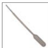
n°1 **Pipetta Pasteur** dosatrice da 3 ml che consente una semplice ma efficiente disposizione della fenolftaleina lungo il taglio sottile della provetta.
