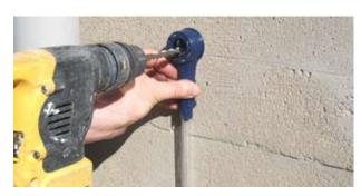
Utilizzando un comune trapano a percussione con punta per muratura, si esegue la perforazione del calcestruzzo procedendo con velocità costante per tutta la durata dell'operazione. La prima polvere in uscita viene raccolta sul fondo della provetta e l'ultima sulla sommità della stessa. L'impiego di un contenitore trasparente consente di verificare il regolare afflusso di polvere durante la perforazione. Il risultato è un campione di polvere ordinato all'interno della provetta.
