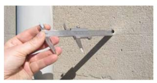
Al termine della perforazione è necessario mantenere in posizione verticale il dispositivo di raccolta completo del campione in provetta. Utilizzando il righello con scala graduata in dotazione si determina con precisione la lunghezza del campione di polvere prelevato, che va rapportato con la misurazione dell'effettiva profondità del foro nel manufatto.
